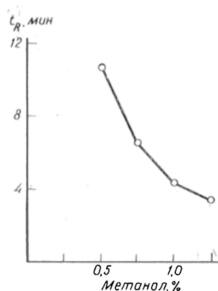
Рис. 2. Зависимость времени удерживания кортикостерона от концентрации метанола в подвижной фазе.
